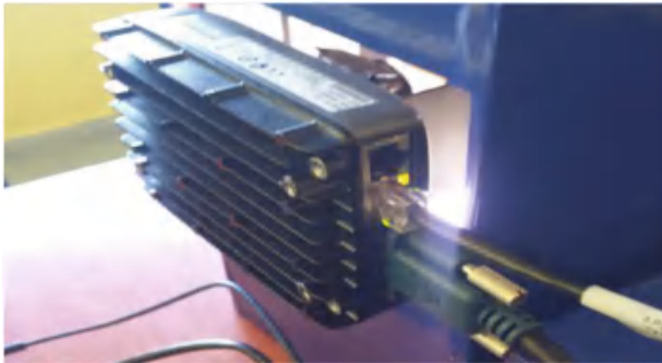
Fig. 27. NI smart camera 1742
